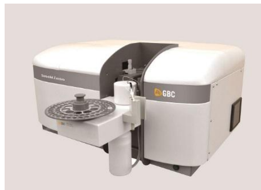
Slika 4: Grafitna tehnika atomske apsorpcijske spektroskopije (18)
