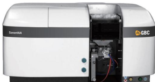
Slika 3: Plamena tehnika atomske apsorpcijske spektroskopije (17)
