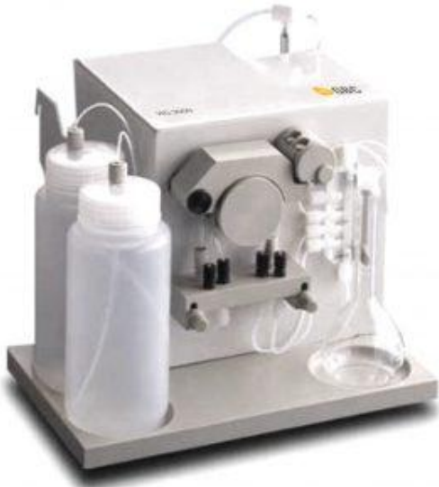
Slika 5: Dodatak za hidridnu tehniku koji se postavlja na uređaj za plamenu tehniku (19)
