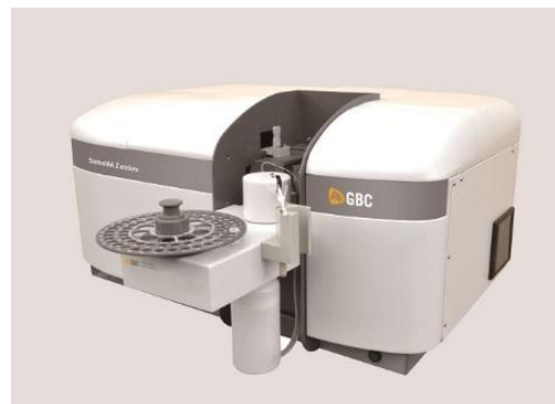
Slika 4: Grafitna tehnika atomske apsorpcijske spektroskopije (18)
